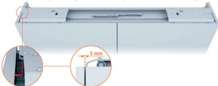
B. Sulla parte inferiore, agire sulla vite M5 presente lateralmente in ogni carrello.
